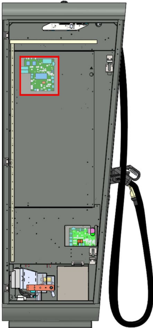
Abbildung 25: Position der CTRL_COM im Hypercharger
